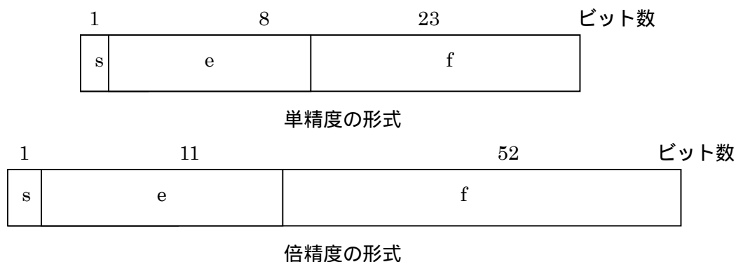
図 2：VPP の浮動小数点の形式
