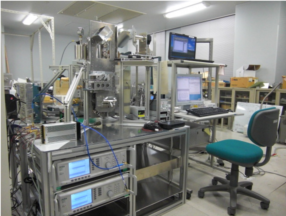
コルゲート(溝付き)ホーンをつ けた250GHz帯超伝導ミキサ
